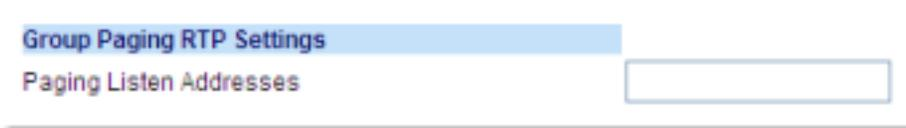
2. En la casilla de texto **Búsqueda direcciones de escucha**, introduzca las direcciones IP multidifusión y el número de puerto en el cual escucha el teléfono para recibir paquetes entrantes multidifusión RTP. Ingrese la dirección IP en formato decimal con puntos (por ejemplo, 239.0.1.15:10000, 239.0.1.20:15000) Puede ingresar hasta 5 direcciones de multidifusión de escucha. Si este campo está en blanco, la capacidad de escucha de paginación está deshabilitada en el teléfono.
