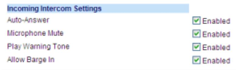
2. El campo **Respuesta automática** está activado de forma predeterminada. La función de respuesta automática está activada en el teléfono IP para las llamadas intercom entrantes. Para desactivar este campo, desactive la casilla de verificación.
