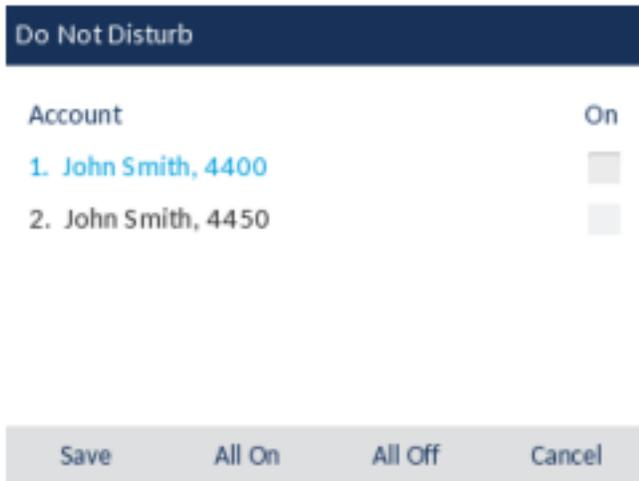
2. Blättern Sie mit der oberen und unteren Navigationstaste durch die Konten und aktivieren Sie dann mit der Auswahltaste die Funktion „Nicht stören“ für das ausgewählte Konto.
