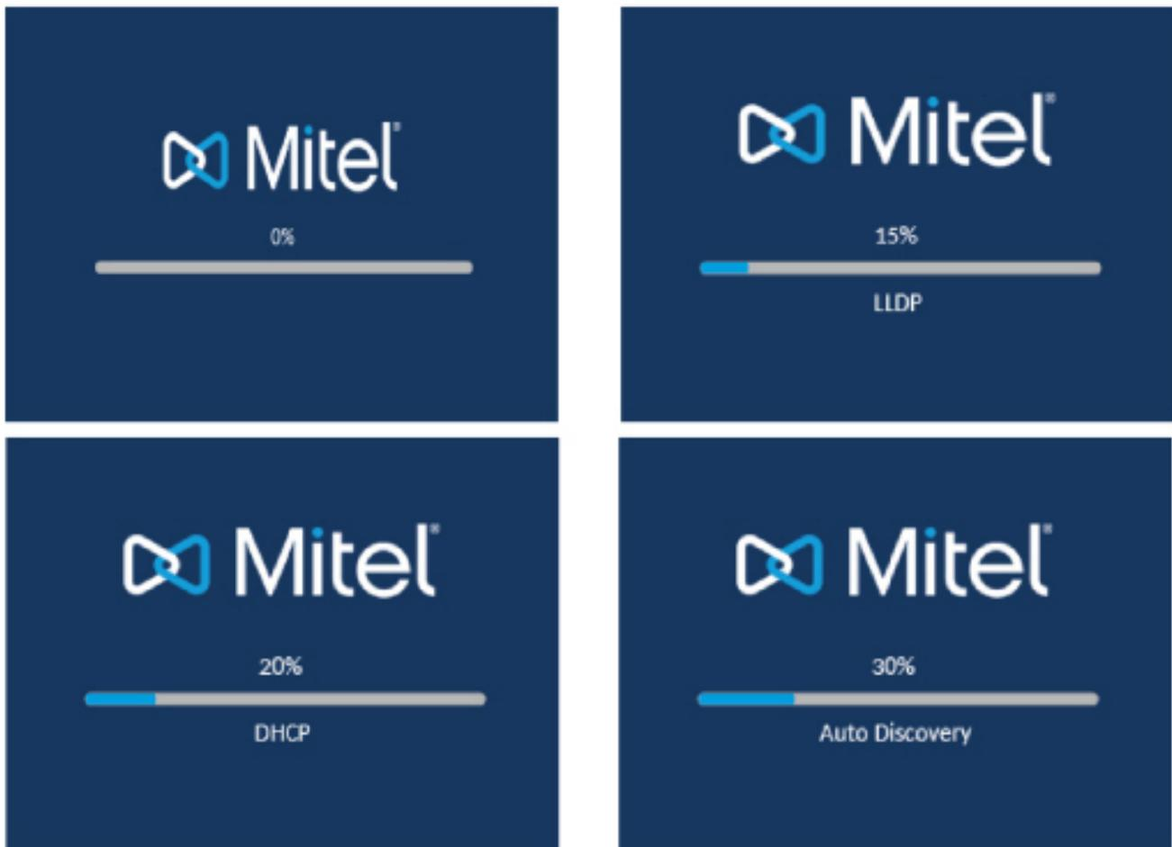
Die Telefoneinstellungen werden überprüft und auf dem Konfigurationsserver wird nach neuen Konfigurationsdaten und Firmware-Aktualisierungen gesucht. Es kann einige Minuten dauern, bis neue Aktualisierungen auf das Telefon heruntergeladen wurden.
