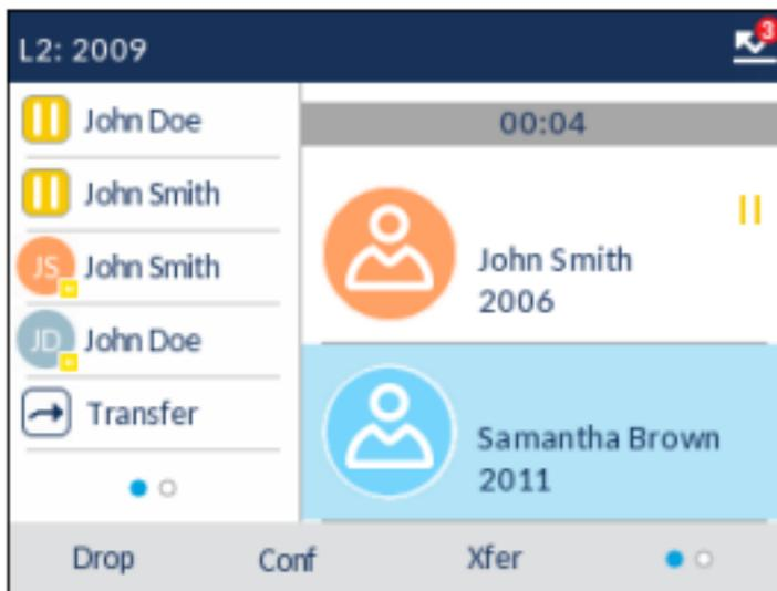
3. Betätigen Sie den Softkey **Weiterleiten** oder
