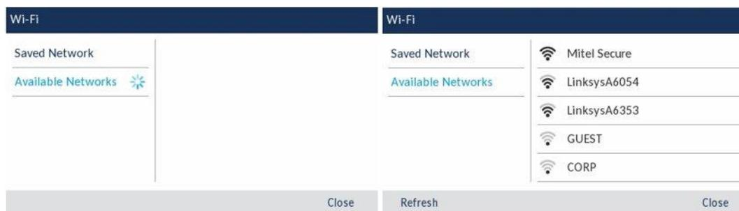
6. Wählen Sie unter **Verfügbare Netzwerke** eine SSID (d.h. den Namen eines Wi-Fi-Netzwerks, z.B. Mitel Secure) aus, um eine Verbindung herzustellen. Wenn die SSID zu einem verschlüsselten Netzwerk gehört, werden Sie aufgefordert, ein Kennwort einzugeben.
