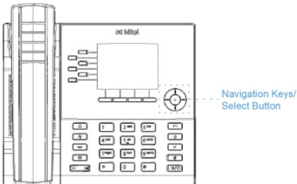
Das Navigationstastenfeld verfügt über vier Richtungstasten (oben, unten, links und rechts) für die Navigation in den verschiedenen Anwendungs- und Einstellungsmenüs. Die mittlere Taste dient als **Auswahl-taste**, mit der die Auswahl einer Option und die Ausführung einer Aktion bestätigt werden kann, z. B. das Wählen einer Nummer aus der Anwendung **Kontakte** oder **Anrufverlauf**.
