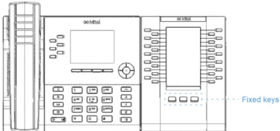
Das Mitel M695 PKM verfügt über ein LCD-Farbdisplay mit einer Bildschirmdiagonalen von 4,3 Zoll, einer Auflösung von 480x272 Pixeln und Hintergrundbeleuchtung und bietet zusammen mit dem Mitel MiVoice 6920 IP Phone ein einheitliches Benutzererlebnis.
