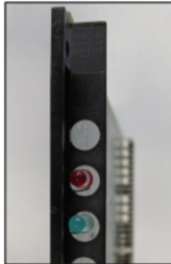
Abbildung 125: TMEW2 – LEDs in der Frontblende
