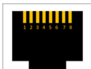
Abbildung 21: DIUT3 – Anschlussbelegung der RJ45-Buchse an der Frontblende
