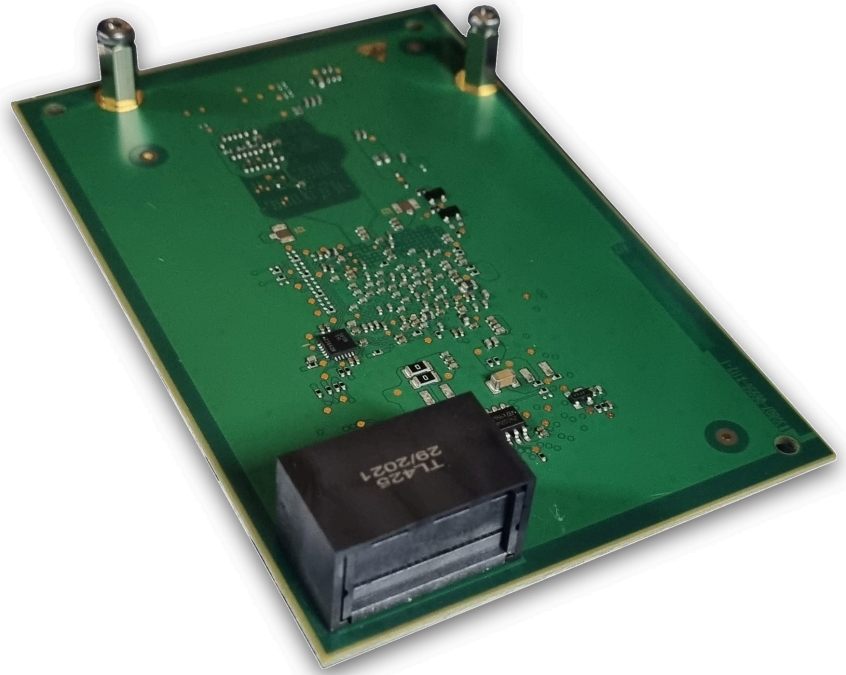
Abbildung 12: Beispiel OCCBL - Rückseite mit gesteckten Abstandsbolzen
