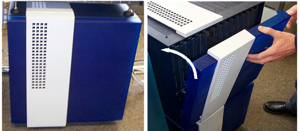
Figure 14: Rimuovere la copertura AP3700-9
