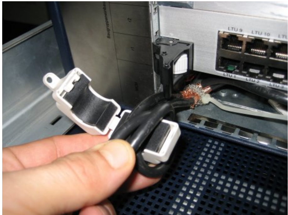
Figure 54: Avvolgimento dei cavi DC attraverso il nucleo in ferrite
