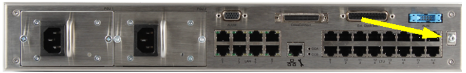
Figure 99: EcoServer - collegamento equipotenziale
