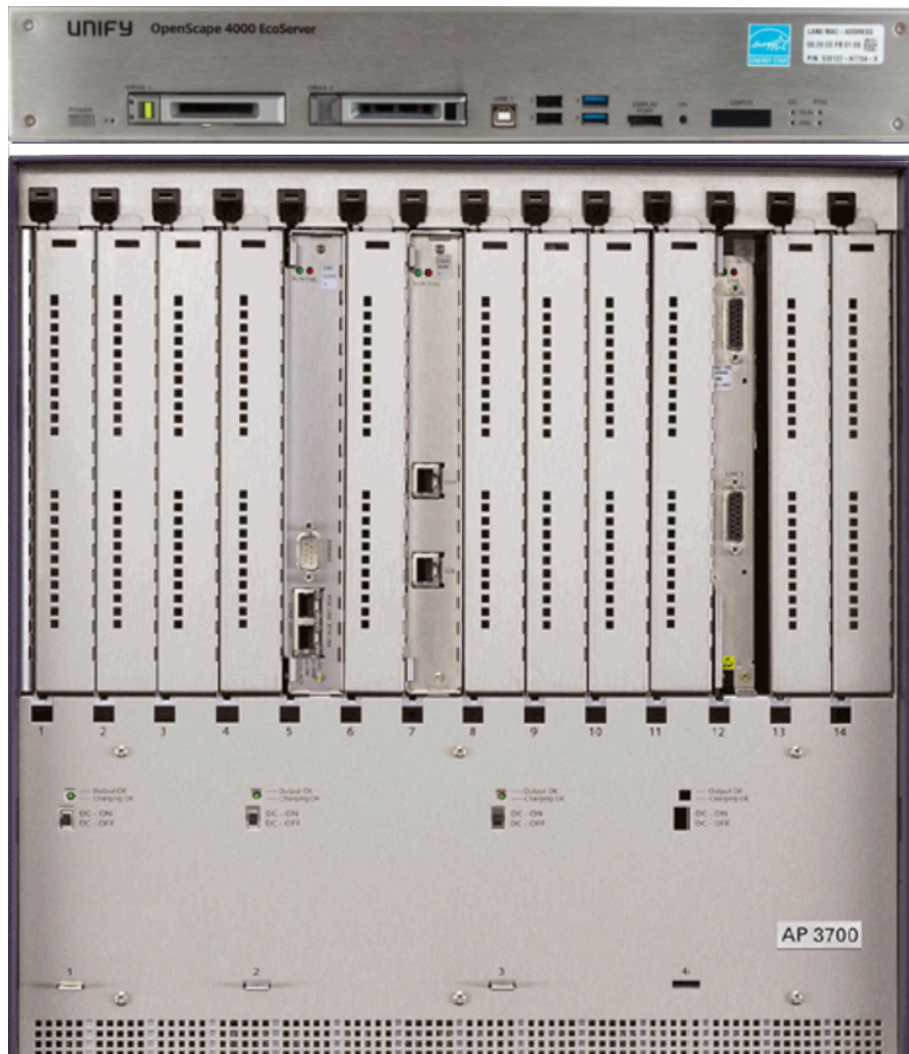
OpenScape 4000 Enterprise Gateway â€œ EcoServer und AP 3700-13 mit LTUCR-Baugruppe
