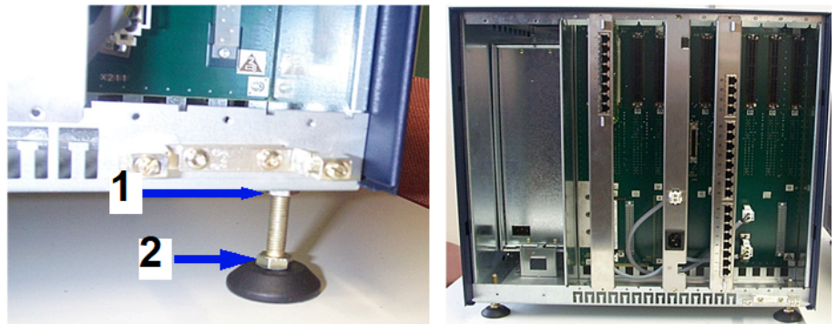
Figure 11: Adattare l'altezza dei piedini
