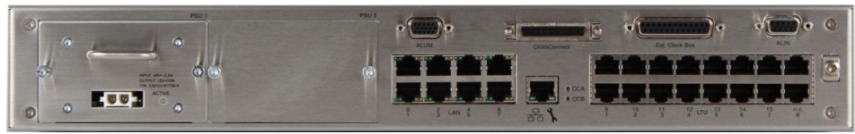
Figure 122: Alimentazione CC di EcoServer
