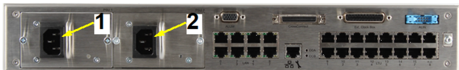
Figure 115: Alimentazione CA di EcoServer
