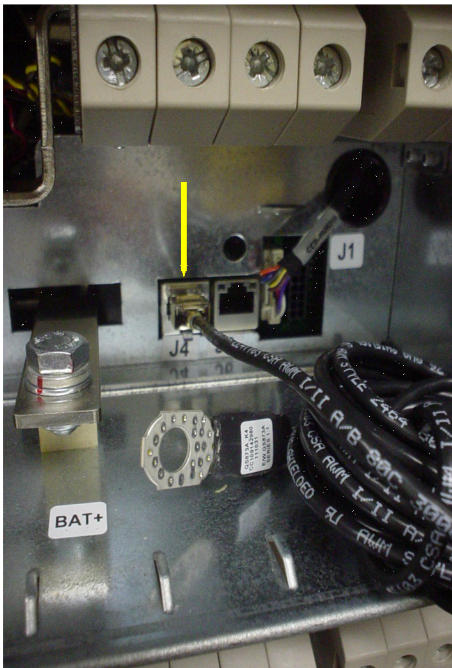
Figure 153: Connessione J4 della sonda della temperatura
