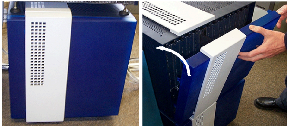
Figure 14: Rimuovere la copertura AP3700-9
