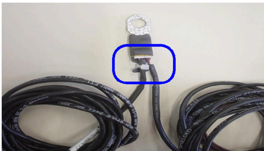
Figure 155: Connessione della sonda termica per portascדה A e B
