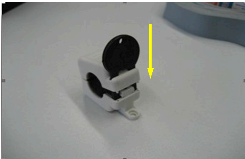
Figure 58: Pressione dello strumento a chiave nell'alloggiamento del nucleo in ferrite
