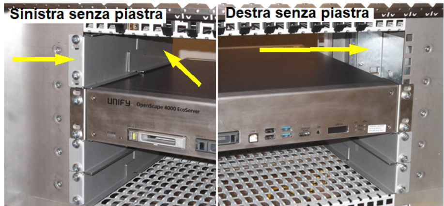
Figure 44: Piastra di ventilazione sopra EcoServer nel funzionamento Simplex
