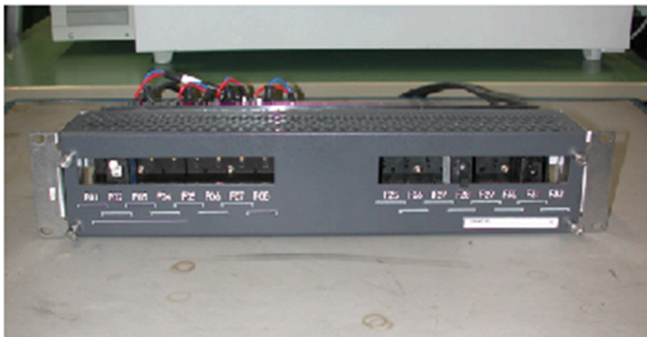
Figure 137: Unità di sicurezza DCDR per installazione a 19"
