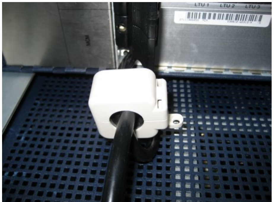
Figure 49: Nucleo in ferrite chiuso con cavo AC
