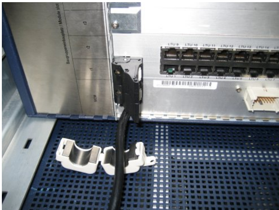
Figure 47: Nucleo in ferrite aperto sotto il cavo AC
