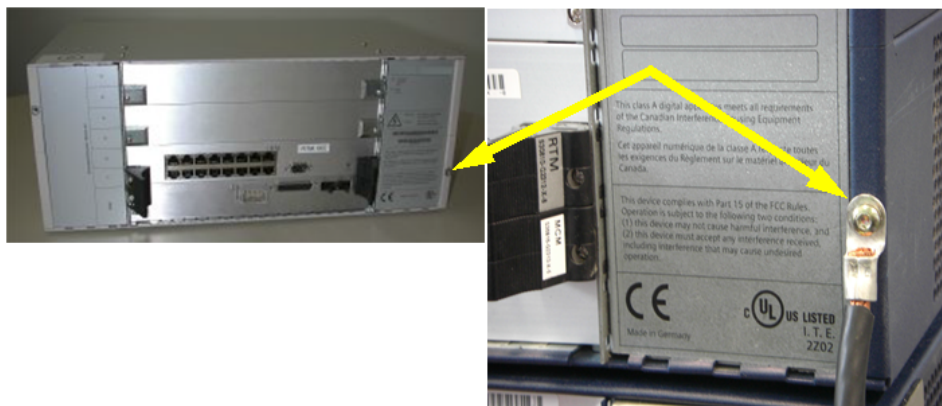
Figure 98: Scheda madre CSPCI - Conduttore equipotenziale
